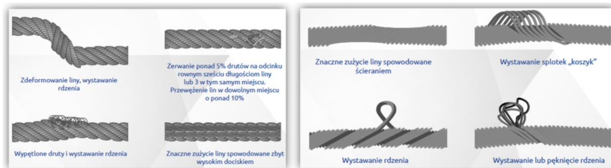
Rysunek 21 Zawiesia linowe – znamiona uszkodzeń
